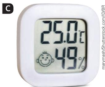
Monitor digital indicando temperatura ambiente (em °C) e umidade relativa do ar.
